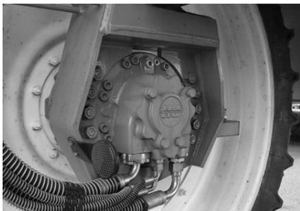
Рис.4.18 –Гидромотор колеса
