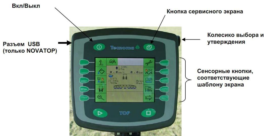
Рис.2.39 – Блок управления NOVATOR
