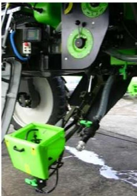
Рис.4.2. – Воронка для введения фитосанитарного продукта, кран (Е) на линии всасывания
