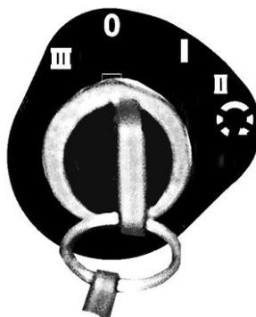
Рис.2.13 – Схема положений выключателя стартера и приборов
