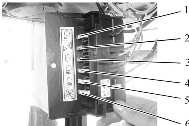
Рис. 2.26 – Предохранители, расположенные в верхнем отсеке кабины
