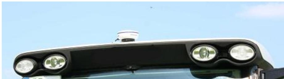
Рис. 4.7 – Антенна GPS-навигации
